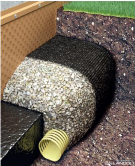
„Landogeo™ Filter ist ein PE-Monofilgewebe und besteht aus einem zwei Fadensystem (Kette und Schuss), das in einer Ebene und im rechten Winkel miteinander zu einem zweidimensionalen Flächengebilde verkreuzt wird.“
