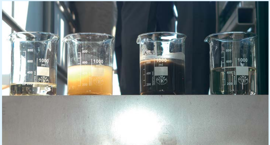
Messbecher mit den Ablauf-Ergebnissen einer Kleinkläranlage
