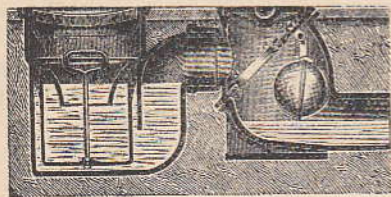
Abb. 106. Selbsttätiger Rückstauverschluß in Verbindung mit einem Fußbodeneinlauf.
