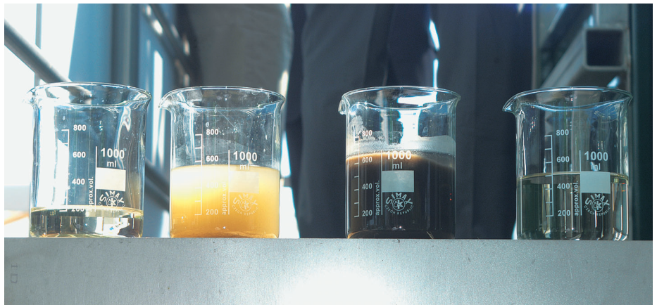
PROBEN: Abwasser und gereinigtes Abwasser im Test
